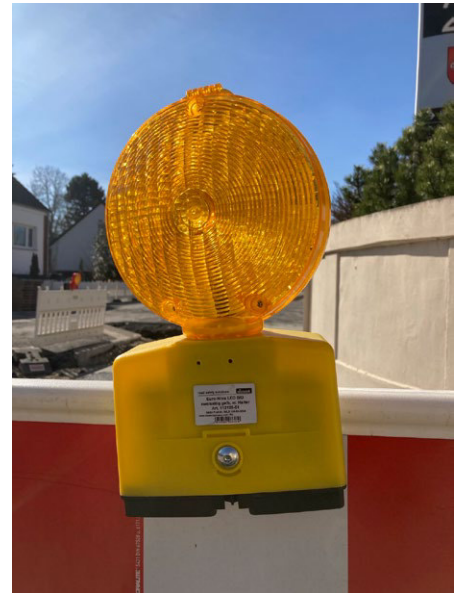
Die Baustellenleuchte mit LOC.id-Empfangsmodul kostet knapp 500 Euro. Vor dem LBZB in Hannover ist sie Teil des Testfeldes.
