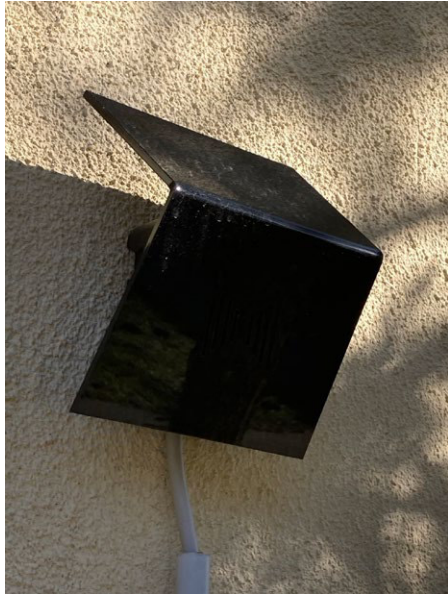
Die Empfangsmodule „LOC.id POI“ bringt man zum Beispiel an Laternenpfählen oder Gebäuden an.
