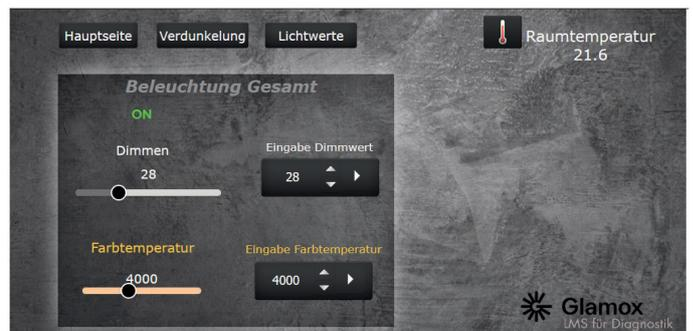
Abbildung 3: Darstellung auf dem Tablet zur Steuerung der Beleuchtungsstärke und der Farbtemperatur
