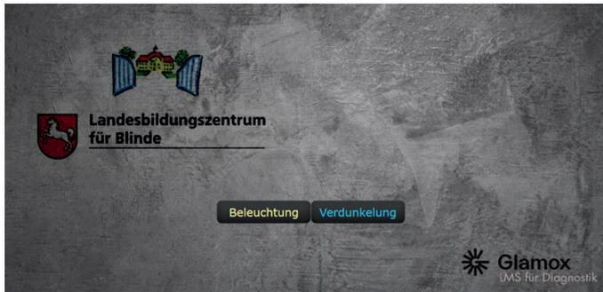
Abbildung 1: Darstellung auf dem Tablet zur Anwahl der Verdunkelung oder der Beleuchtung
